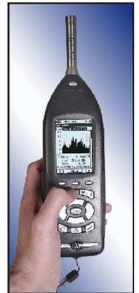
La strumentazione è stata controllata prima e dopo il ciclo di misura, secondo la norma IEC 60942 (1997), con calibratore QUEST TECHNOLOGIES tipo CALL-200 mat. n° 5662, di CLASSE 1 e conforme alle norme CEI 29-4.-
